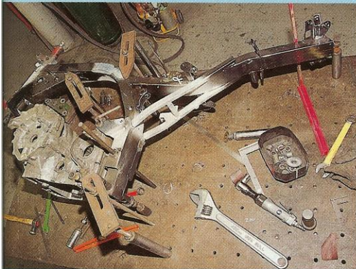
pour retrouver le bon alignement des fixations moteur, on met des carters en place et on redresse le cadre.
